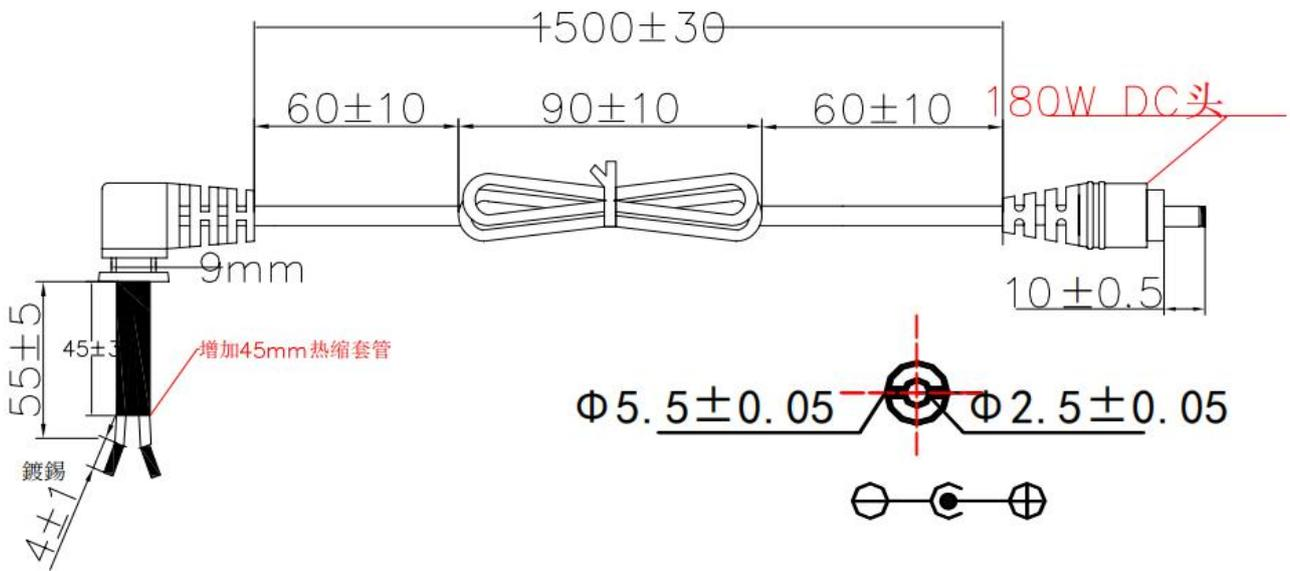
注: DC输出线 UL1185 16AWG 1500mm DC头为
